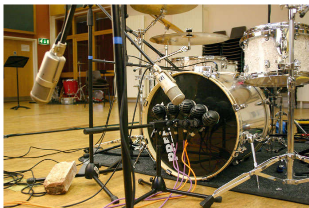
Foto van de achterkant van de ketel. Je ziet een aantal AKG D112's en een Neumann U47 op verschillende afstanden.
